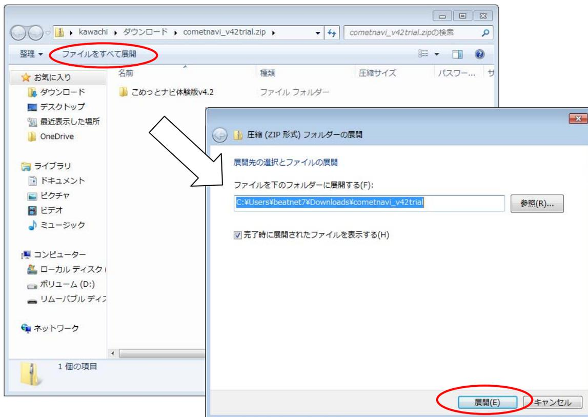
04.正しく展開されました。Setup.exe をダブルクリックしてセットアップを行ってください。
